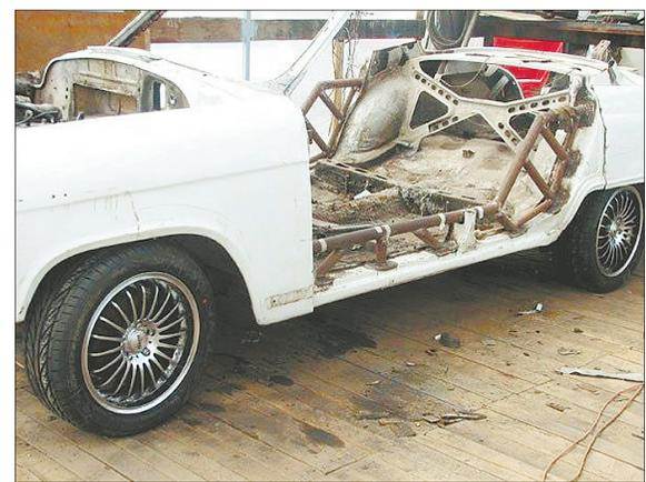
Кузов волгоградец укрепил железными штангами, идущими по всему периметру машины.
